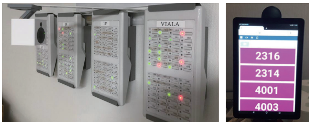
インジケータの情報をWebカメラが読み取り作業者の端末に自動送信
